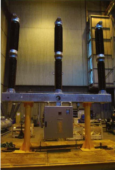
Slika 1. Prekidač 8E1-III, nazivni napon 123 kV
